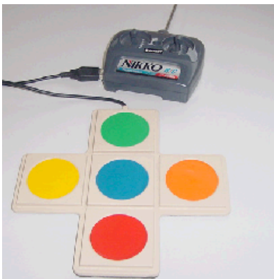
Branchement d'un contacteur multiple TASH sur la télécommande
