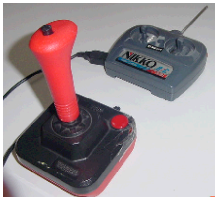
Branchement d'une manette 4 contacts sur la télécommande
