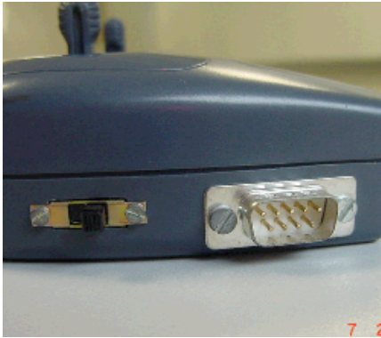
Inverseur et connecteur 9 broches montés en façade du boîtier de télécommande
